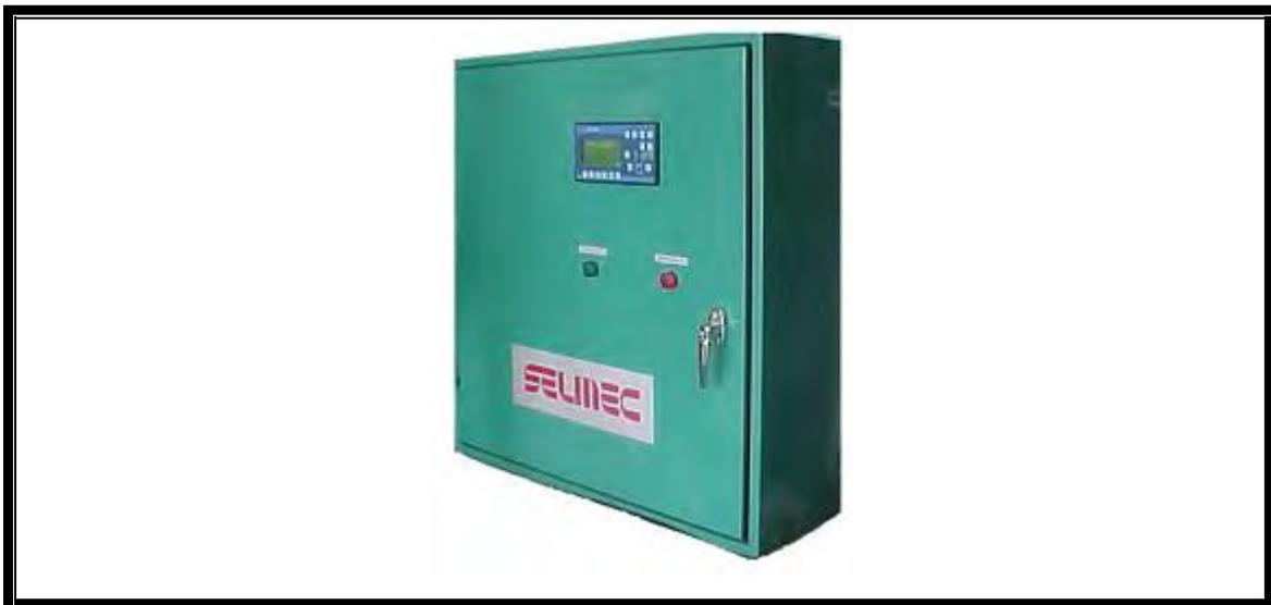
Fig. 3.19 Control de Transferencia de energía de la planta o de la línea hacia la carga. Se utiliza un control digital programable. Tiene un cargador de baterías de 12 o 24 Vcd. Se fabrican para transferencias de 220 o 440V. 1 o 2 marchas. Con comunicación remota, opcional. Selector para operación manual, automática o fuera. Paro de emergencia. Opcional reloj programable para arranque semanal, entre otras funciones.
