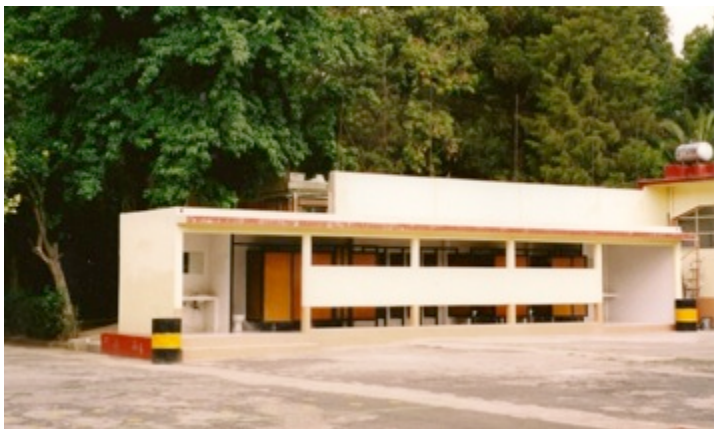
Imagen no. 22 La transparencia y vestibulación de los baños de los escolares permite un control y supervisión a distancia, que evita el abuso y acoso en este local, además de una excelente ventilación, ahí los baños no huelen.
