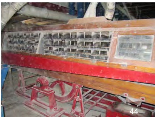
Imagen 44 y 45.- Mesa pady Marca Schule (1946) aún en uso dentro del Molino San José, Jojutla. Foto: IPV.
