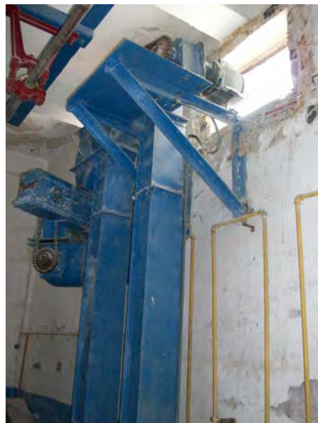
Imagen 165.- Elevadores de arroz en el interior del molino de arroz San José, Jojutla. Foto: IPV 2011
