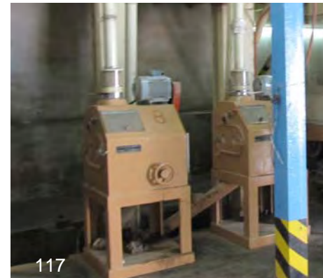
Imagen 115.- descascaradora molino de arroz San José, Jojutla. Foto: IPV
