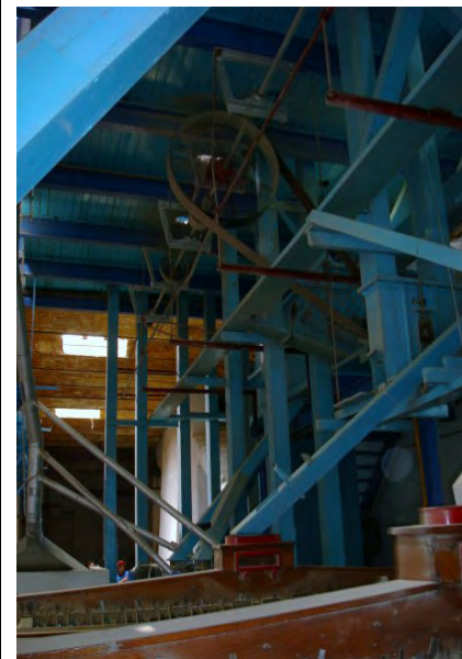
Imagen 164.- Mesa pady, elevadores de canjilones, poleas y correas (transmisores de la fuerza motriz) en el interior del molino de arroz Buenavista en Cuautla,
