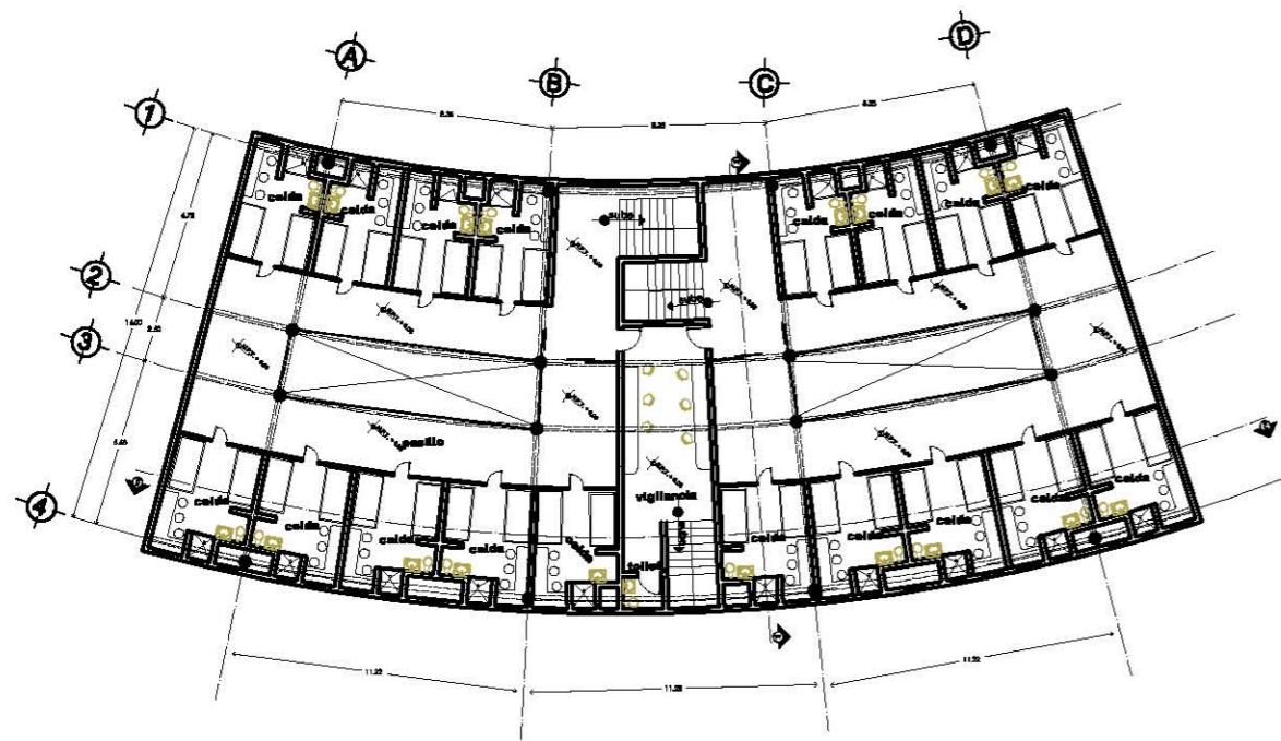
PLANTA ALTA BLOQUE TIPO DE CELDAS
