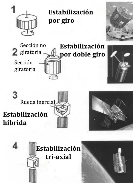
Fig. 1.3. Tipos de estabilización de la orientación en satélites [33].
