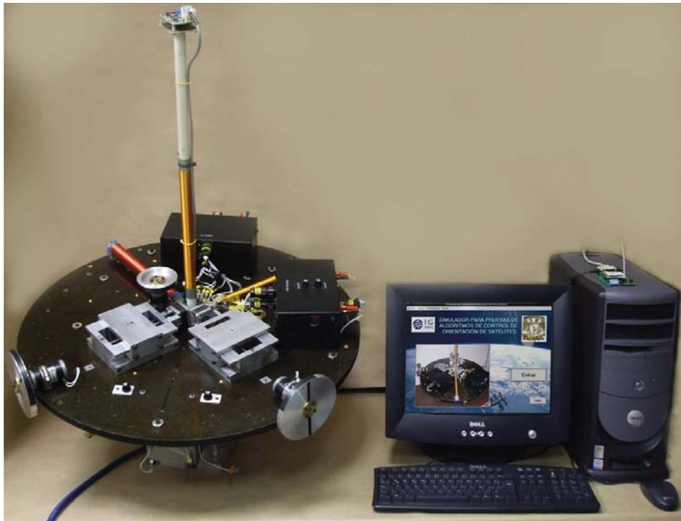
**Fig. B.2. Sistema de simulación completo SIMUSAT\_2.1, a la izquierda se encuentra la plataforma y a la derecha la estación terrestre.**
