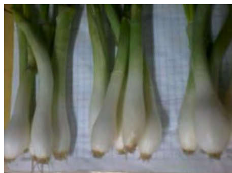
Figura A3.11 Crecimiento después de incubación de 72 horas, de izquierda a derecha agua de CU, muestra 2ppm de cobre ( 7.85 \text{ mgCuSO}_4/\text{L} ) y muestra 10 ppm de cobre ( 39.8 \text{ mgCuSO}_4/\text{L} )
