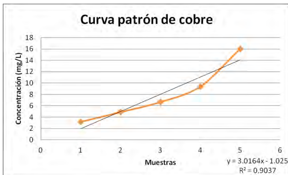
Figura A1.1. Curva patrón de cobre
