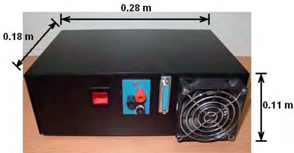
Figura 4.13 Caja electrónica para conversión digital – analógica, polarización y amplificación de corriente para los motores que mueven las platinas X - Y y Z .
