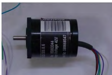
Figura 4.5 Motor a pasos Phytron ZSS 25.500.0.6 para desplazar las platinas.
