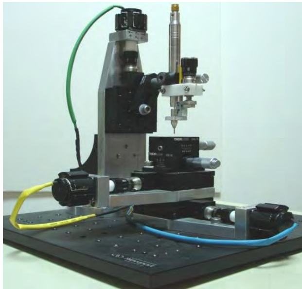
Figura 4.12 Microscopio de microondas ensamblado y terminado listo para funcionar.
