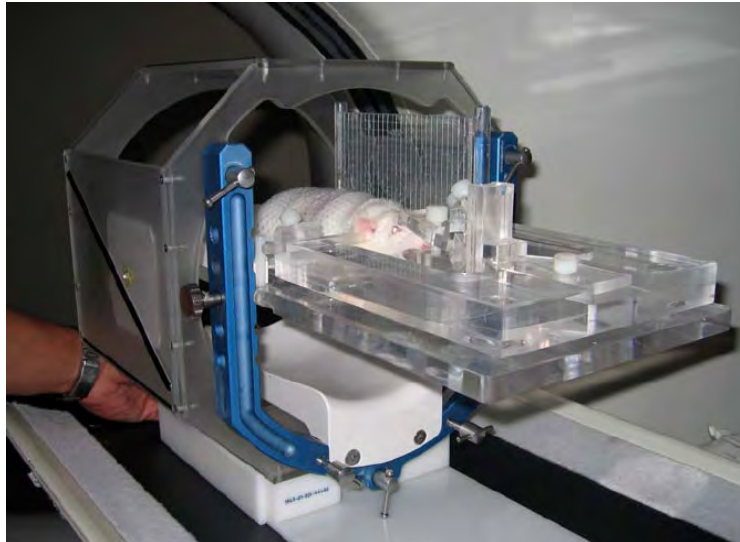
Figura 9. Fotografía de una rata colocada en el sistema de fijación estereotáctica en el momento en que se le realiza la tomografía computarizada con una caja de localización para la planeación del tratamiento. Equipo tomógrafo es helicoidal multicorte (CT/i Hispeed General Electric Inc.)
