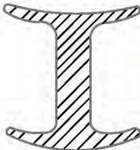
Perfil de silicón extruido que se coloca en la ranura; al expandirse permite colocar el cordón de silicón para sellar.
