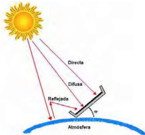
Figura 2.6 Tipos de radiación que inciden sobre una superficie inclinada
