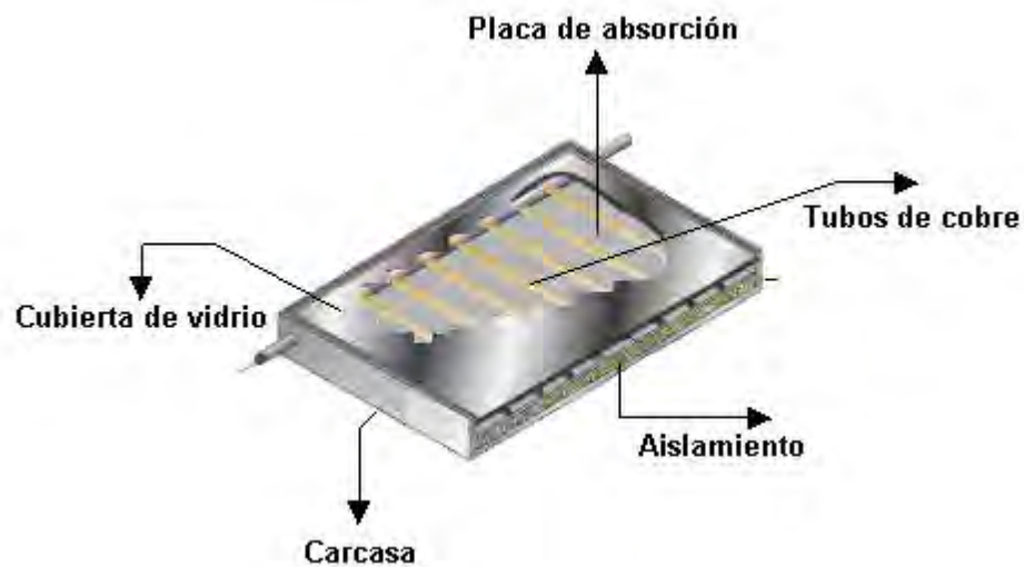
Figura 3.3 Componentes de un colector solar plano
