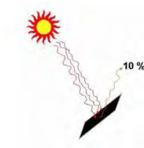
Figura 2.3 Efectos de la radiación solar en una superficie oscura
