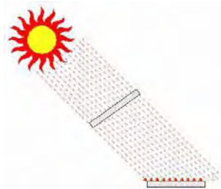
Figura 2.4 Absorción de la radiación directa por una superficie
