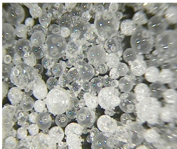
Figura 55. Partículas de poli(estireno) obtenidas a través de la polimerización masa-suspensión (40x). Imagen obtenida de un microscopio estereoscópico.
