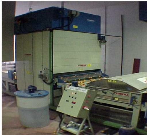
Figura 14. Aplicación de recubrimientos comestibles por aspersion
