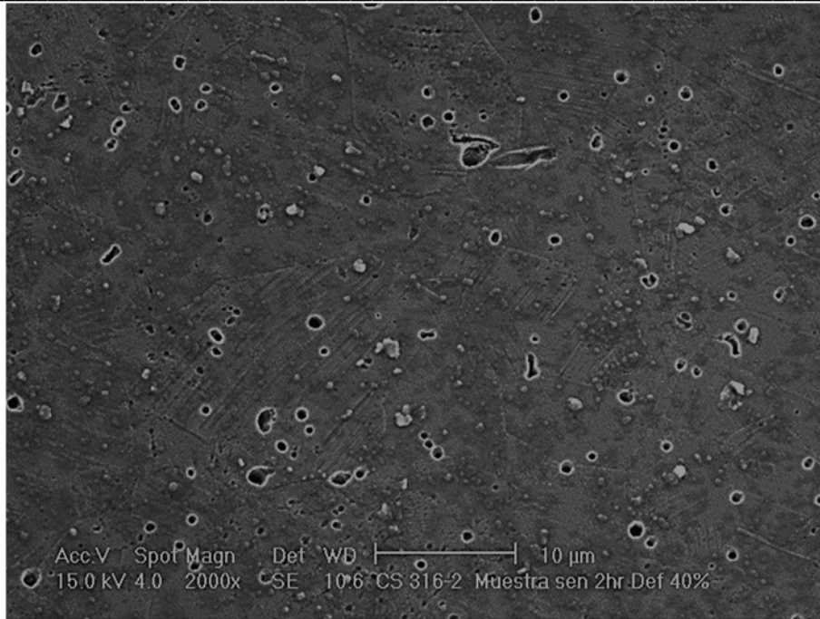
Figura 98. Microestructura de la muestra de AISI 316 con deformación del 40% y tratamiento de sensibilización de dos horas a 2000X.
