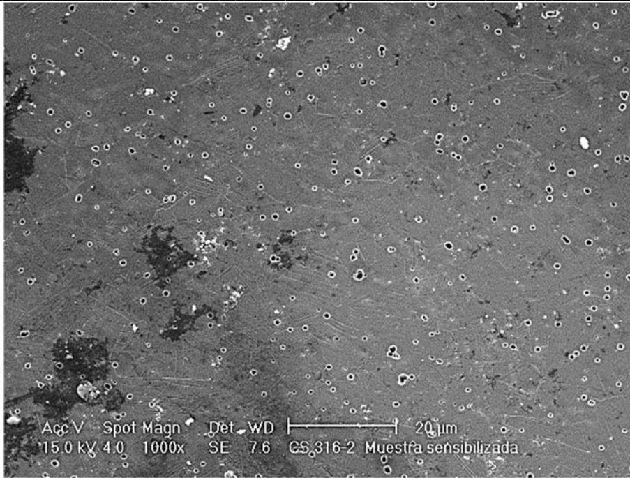
Figura 76. Microestructura de la muestra de AISI 316 sin deformación y tratamiento de sensibilización de dos horas a 1000X.
