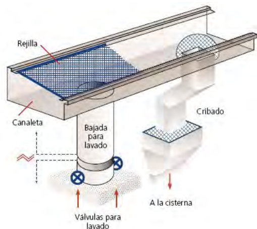
65.- DETALLE DE CANALETAS PLUVIALES .
