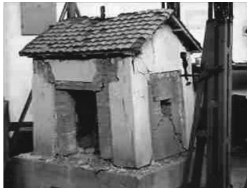
Figura 3.14. Ensaye de laboratorio de una estructura conformada por muros de mampostería confinada
