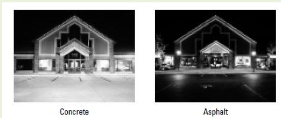
Figura 2.3 Comparación de la iluminación entre superficies de concreto y asfalto.
