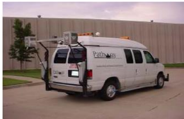
Imagen 3.5 Método automatizado (equipo PathRunner XP).
