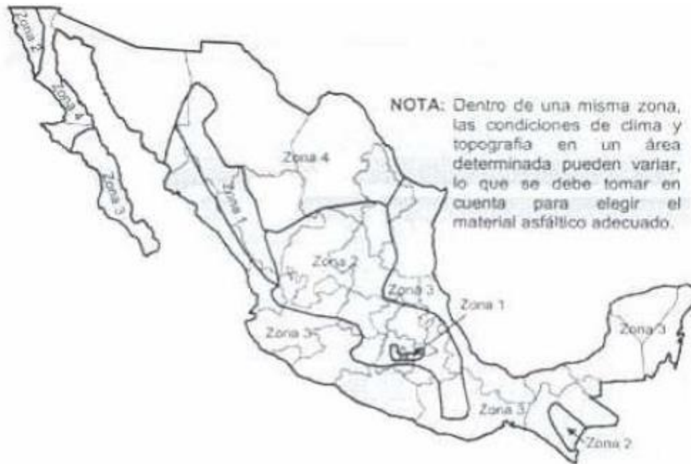
Figura 1.2 Regiones geográficas para la utilización de asfaltos.
