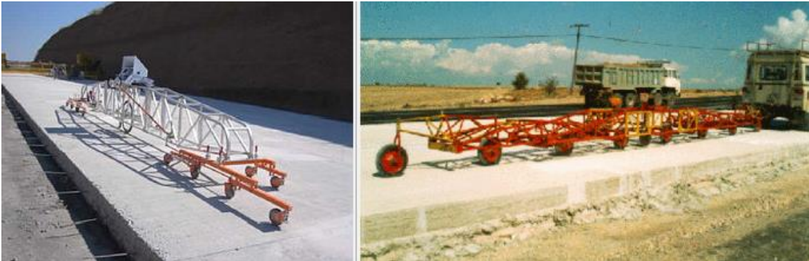
Imagen 3.2 Perfilómetro California (izq.) y Viágrafo (der.)
