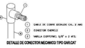
**DETALLE DE CONECTOR MECANICO TIPO GARCAT**
