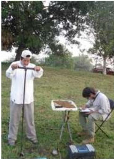
Figura 12. Imagen de la realización de una prueba de barreno y el registro en cédulas.
