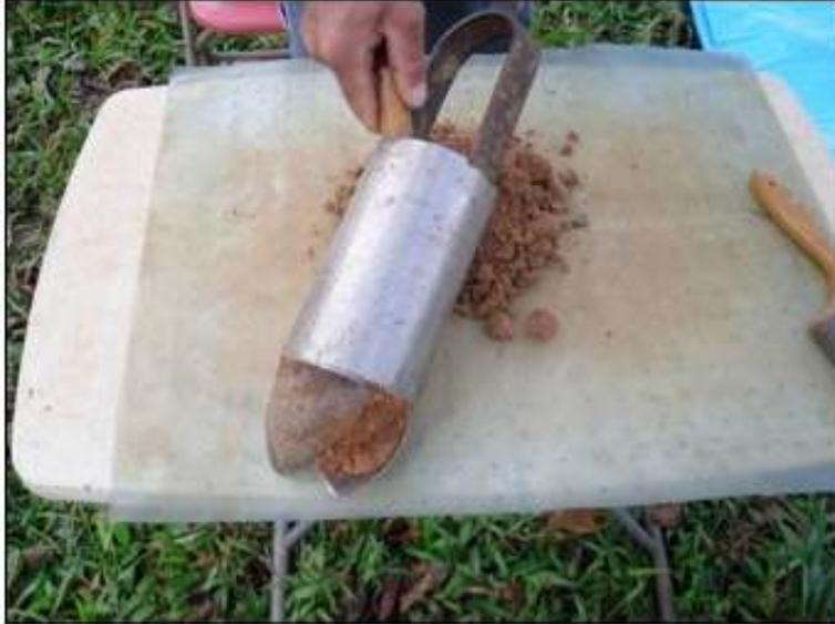
Figura 13. Imagen que muestra la extracción de tierra desde la parte superior de la cubeta con el fin de obtener mejor visibilidad para la distinción de estratos.
