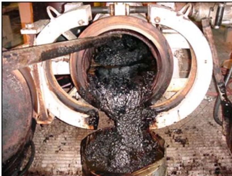
Figura 1.6. Depósito de asfaltenos en líneas de producción<sup>(2)</sup>.
