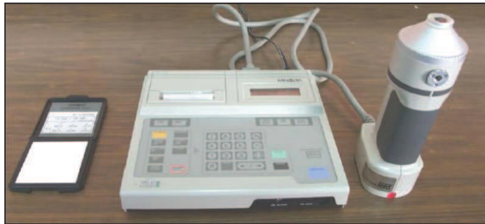
Figura 24. Colorímetro Minolta utilizado en la determinación de color.
