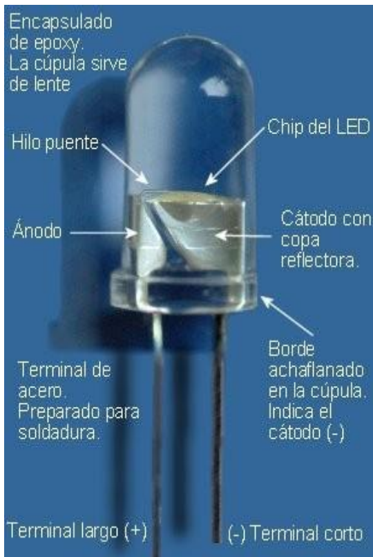
Figura 3.33 Partes del LED.
