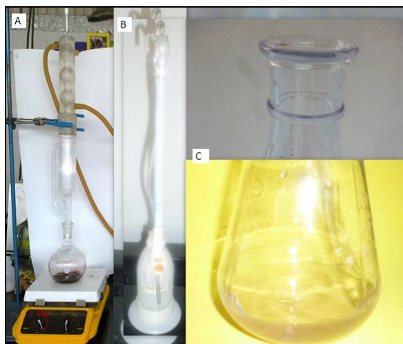
Figura 32. Equipos para la determinación de acidez volátil donde: A) Destilación del vino, B) Valoración con solución de NaOH 0.02 M y C) Vire ligeramente azulado.
