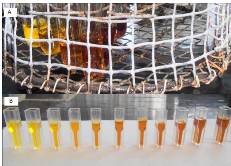
Figura 29. Determinación de azúcares reductores donde: A) Tubos de ensayo para la hidrólisis y B) Celdas para la determinación de curva patrón.
