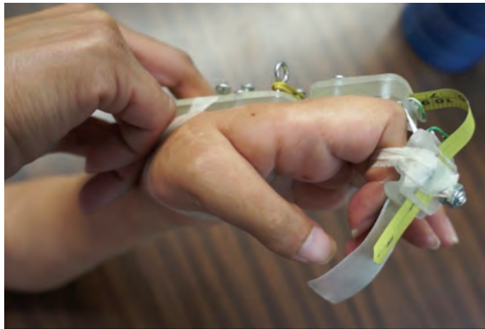
Imagen 32. Prototipo sin retén, mostrando sobre-extensión en la cinta métrica.
