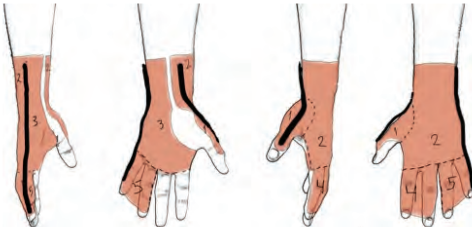
Imagen 36. Las áreas sombreadas representan la superficie final del Neopreno®, las líneas punteadas son las líneas de costura y los trazos gruesos representan los soportes de metal.
