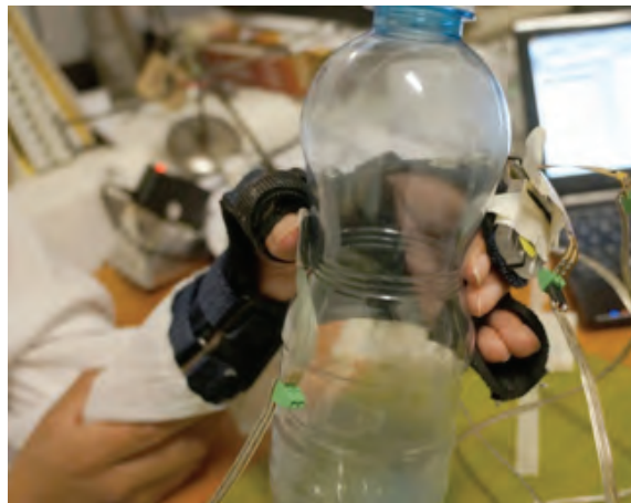
Imagen 44. Sujeción de objeto con 4.2 cm de diámetro.
