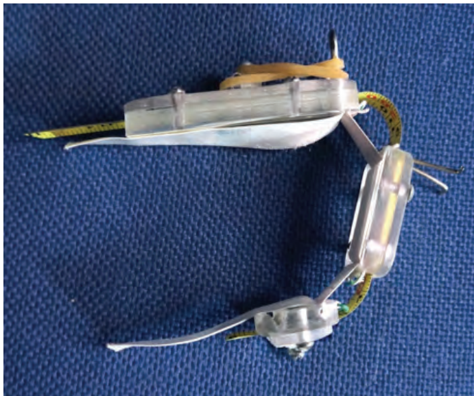
Imagen 29. Prototipo flexionado, con ligas.
