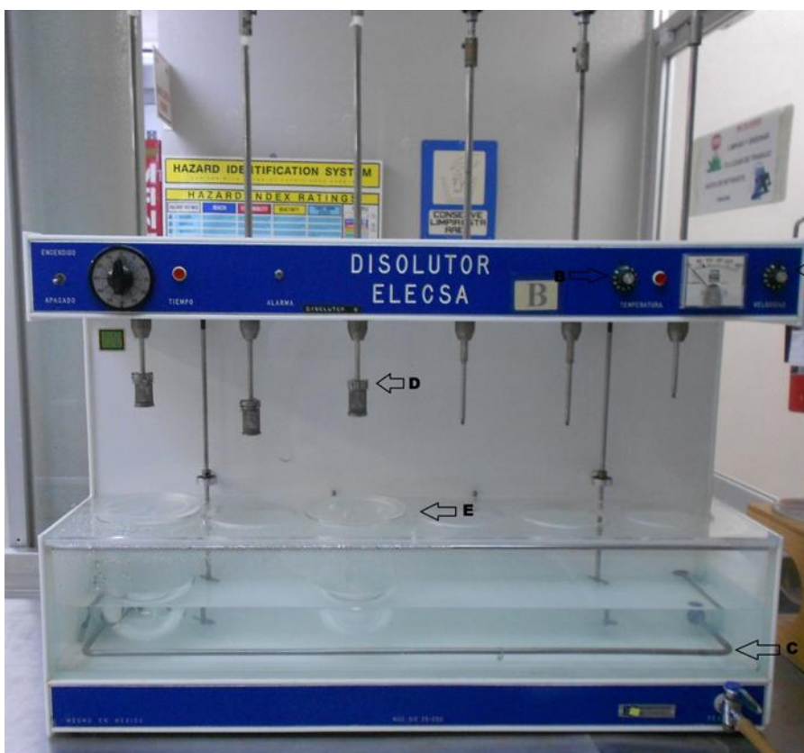
Figura 18 Disolutor ELECSA, Modelo DIE 25-250, Laboratorio de Tecnología Farmacéutica, Facultad de Química, UNAM.
