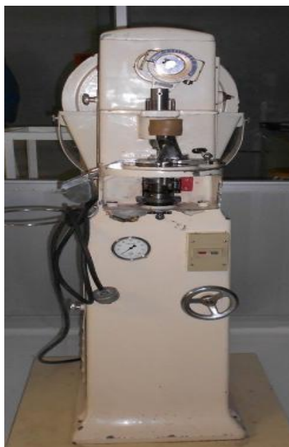
Figura 17 Tableteadora Killian modelo GMBH, Laboratorio de Tecnología Farmacéutica, Facultad de Química, UNAM
