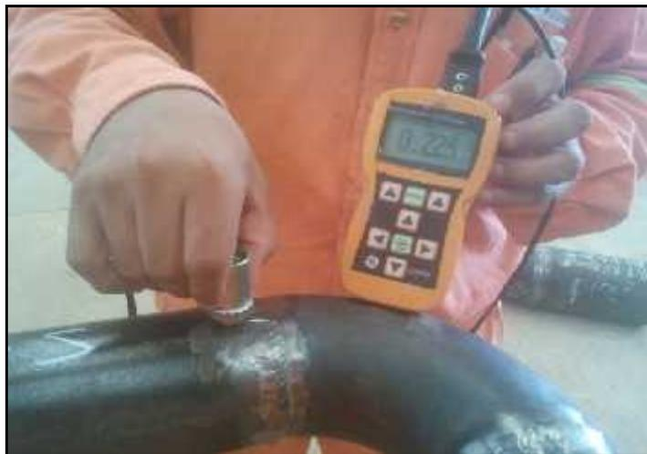
**Imagen 10. Colocación de transductor**
