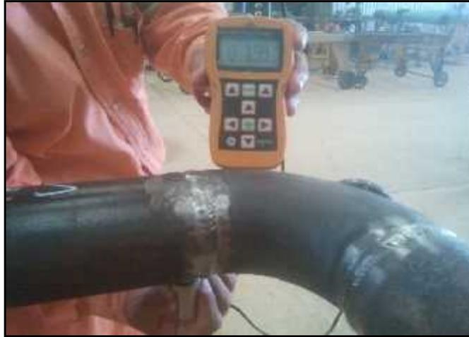
**Imagen 11. Medición de espesores**
