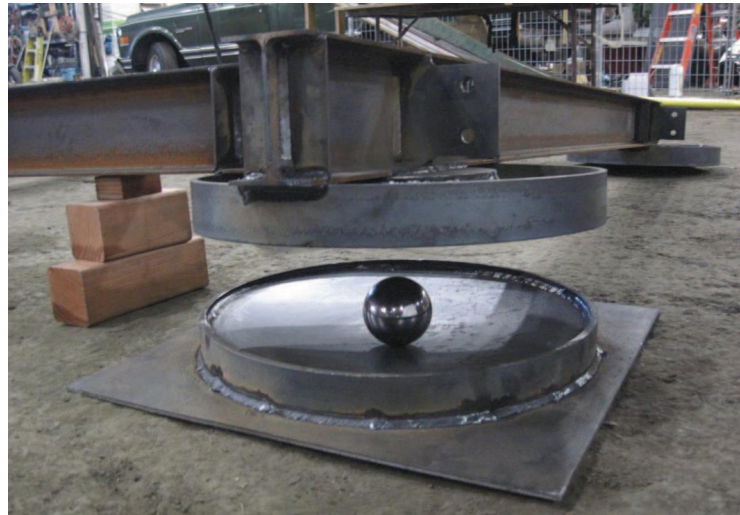
Imagen 1.14. FPS fabricado a escala para el estudio de su comportamiento.
