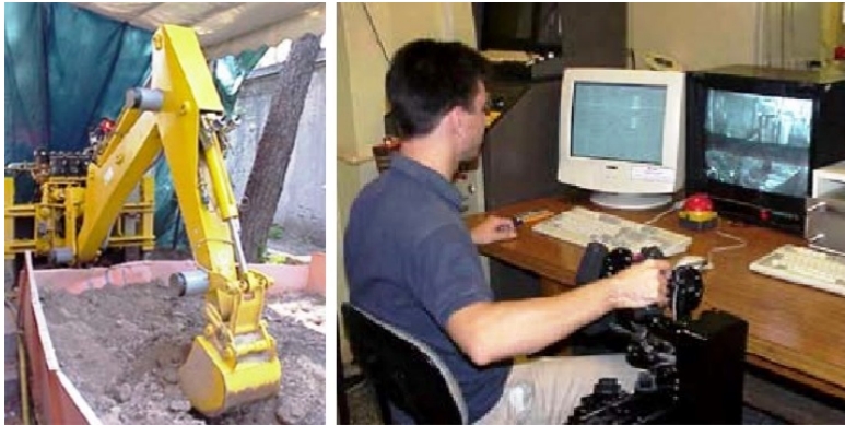
Figura 1.11: Proyecto RETINA: Excavadora teleoperada.
