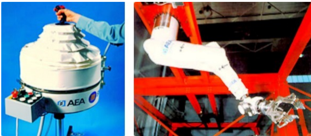
Figura 1.2: Robot maestro(izq) - esclavo(der) para plantas nucleares.
