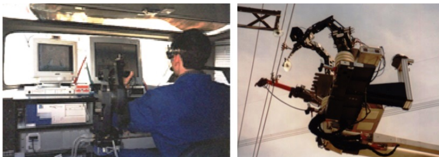
Figura 1.12: Prototipo Robtet para el mantenimiento de líneas de alta tensión.
