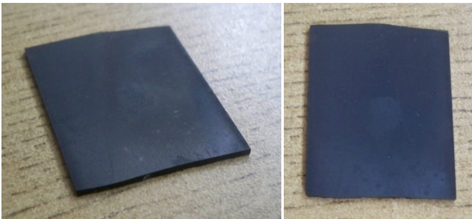
Figura 35 Muestra cristalizada-sulfurizada a 550°C en ambiente de Argón.
