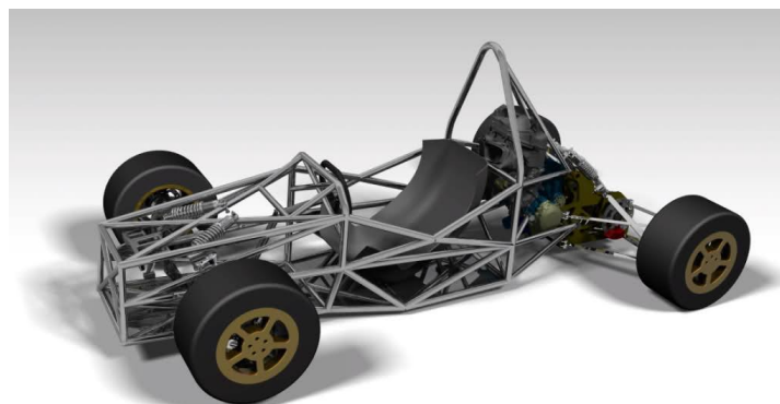
Figura 2.7 Chasis tipo marco espacial de un vehículo Fórmula SAE.
