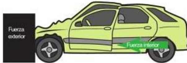
Figura 2.12 Fuerzas generadas en un vehículo durante una colisión frontal. [9]
