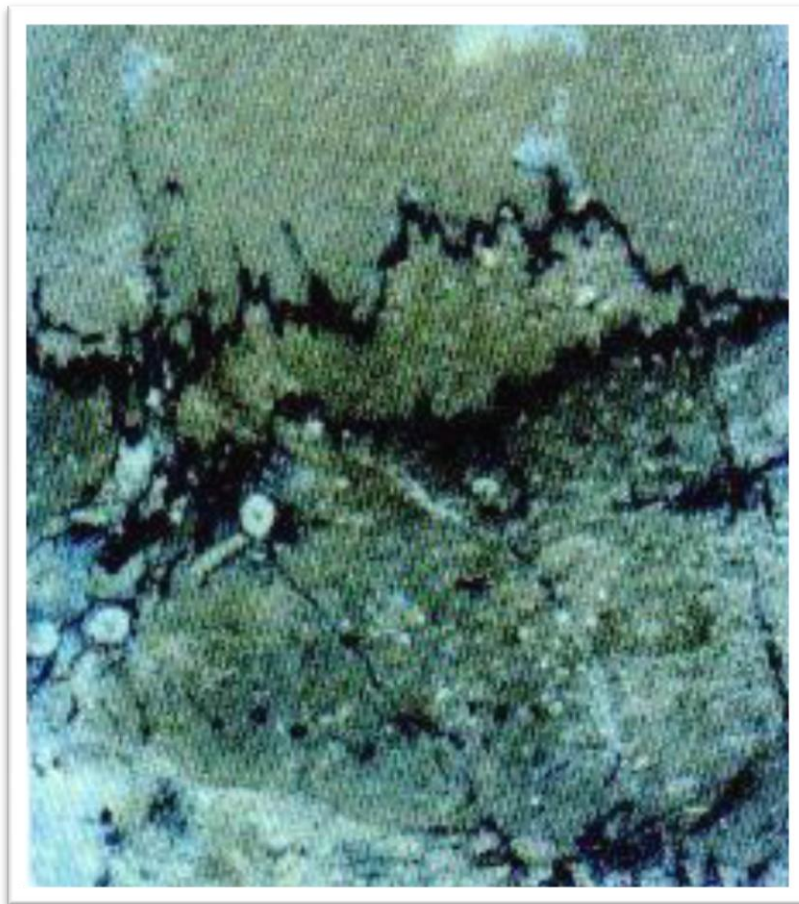
Figura 6.4: Estilolita en caliza del cretácico, el área entre los dientes es la cantidad de roca disuelta (Meneses Larios, Apuntes de Geología de Sistemas Naturalmente Fracturados)
