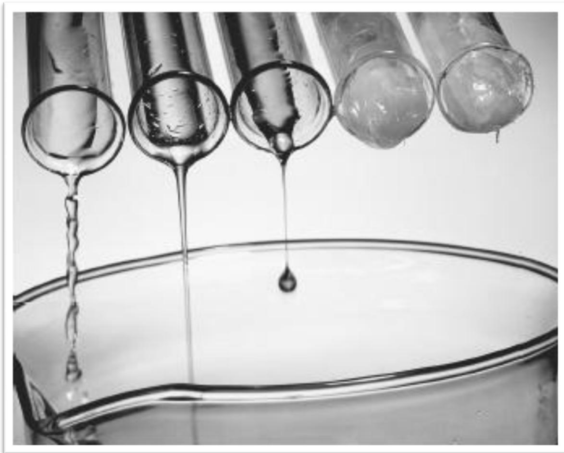
Figura 1.11: Fluidos con diferentes viscosidades, los fluidos de la derecha son más viscosos que los de la izquierda
