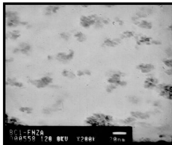
Figura 4.5 Micrografía de la ferrita Ni-Zn, obtenida a partir de la técnica de microscopía electrónica de transmisión.
