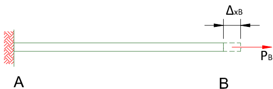
Fig. 3-23. Deformación axial en el extremo B.
