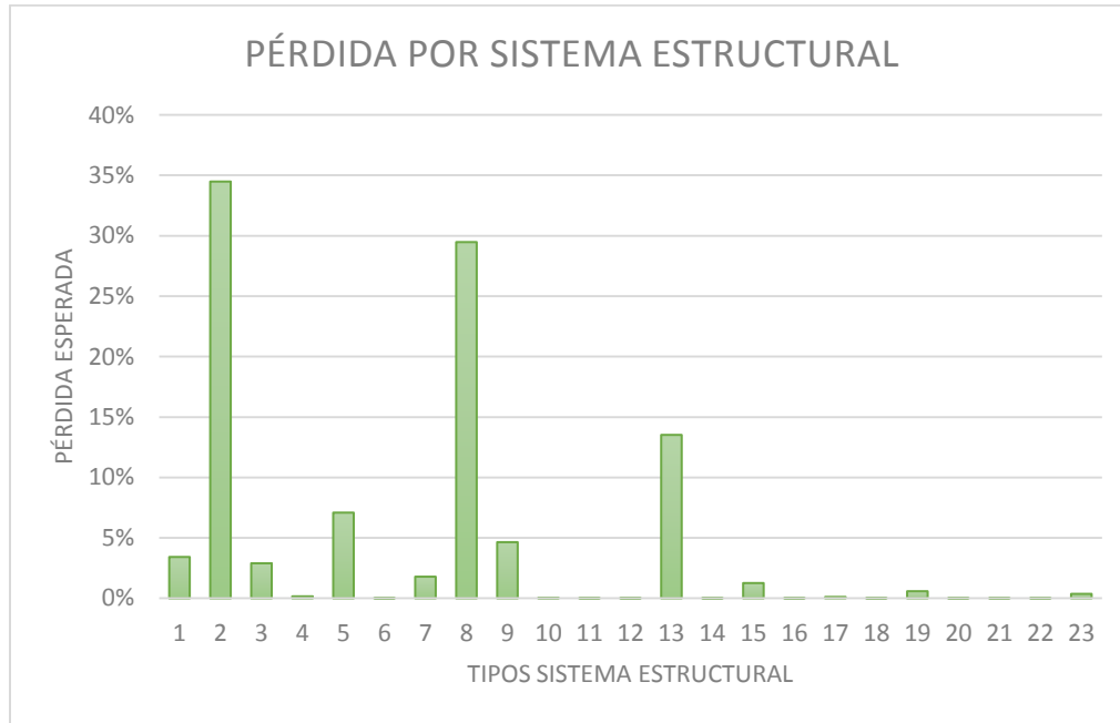
Figura 3. 38 Gráfica de las pérdidas en sistema estructural por el evento de 1985
