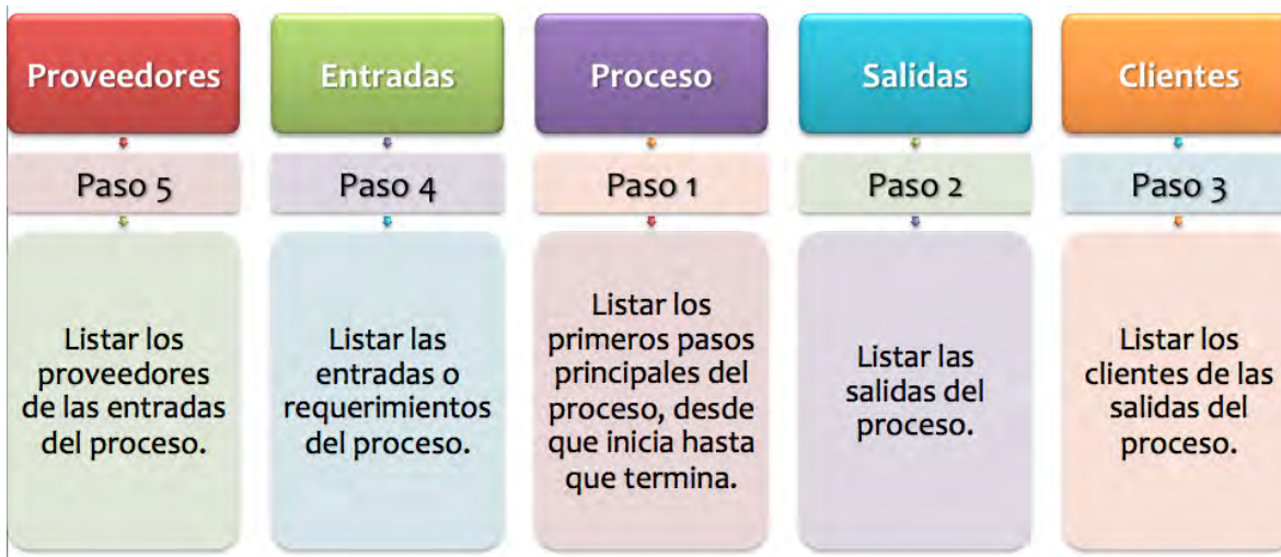
Figura 13. Elementos Mapeo de Procesos
