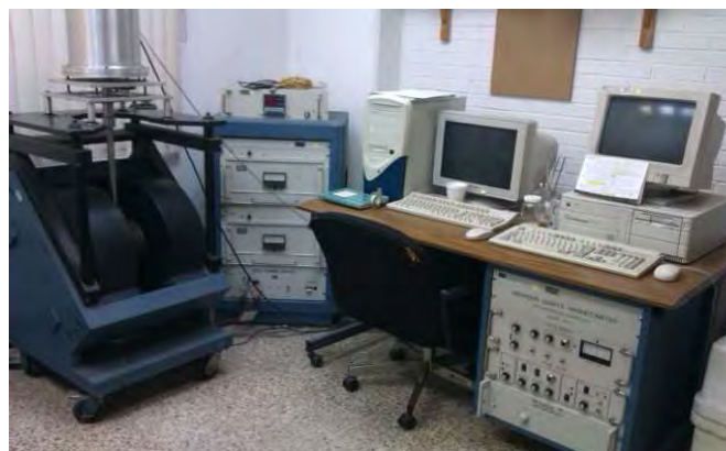
Figura 24. Magnetómetro de muestra vibrante modelo LJDJ 9600.
