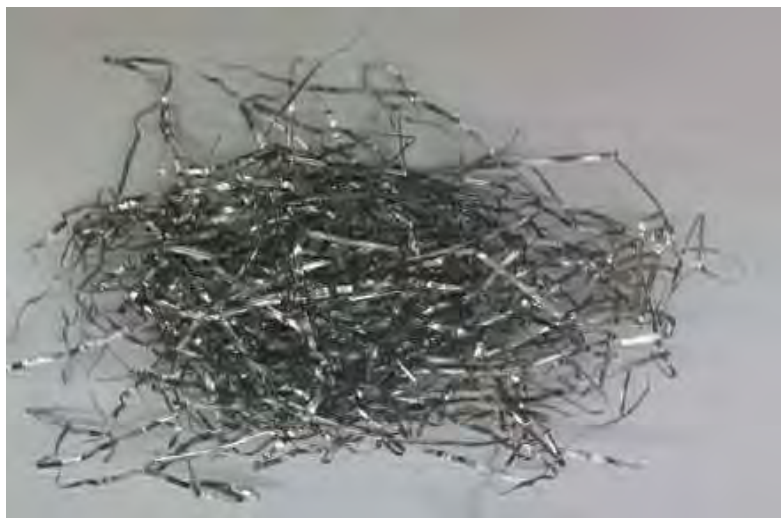
Figura 19. Cintas metálicas \text{Fe}_{49}\text{Co}_{49}\text{Al}_2 obtenidas por solidificación ultrarrápida.
