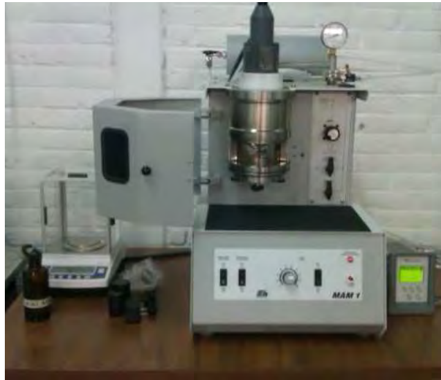
Figura 17. Horno de Arco eléctrico con cámara de vacío controlada por una atmosfera de argón.
