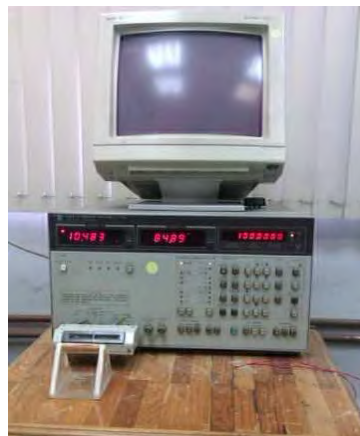
Figura 25. Analizador de impedancias Hewlett-Packard HP4192 A (5-13Mhz) y bobina de cable de cobre con 77 vueltas.
