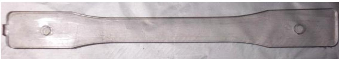
Figura 64. Probeta de policarbonato virgen sin hidrólisis.
