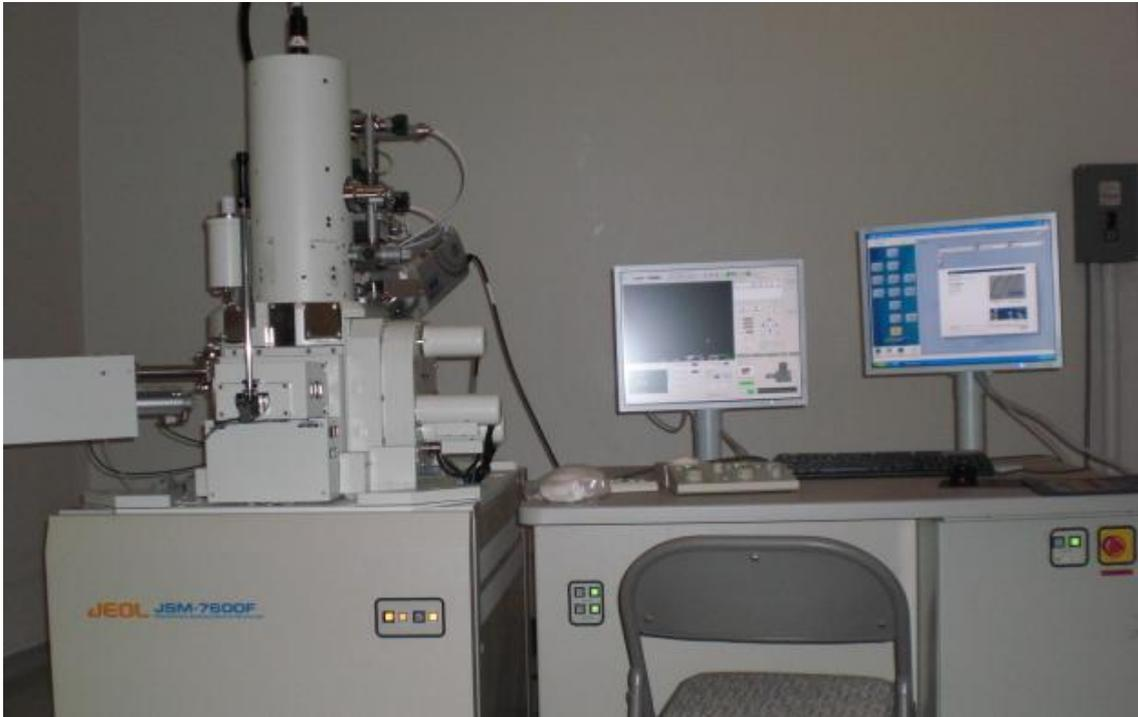
Figura 40. Microscopio electrónico de barrido marca JEOL.
