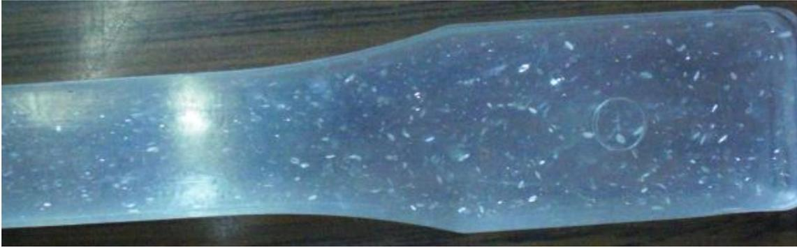
Figura 93. Probeta de policarbonato virgen con 20 ciclos de hidrólisis
