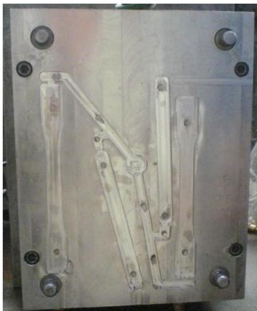
Figura 34. Molde normalizado ASTM-D638
