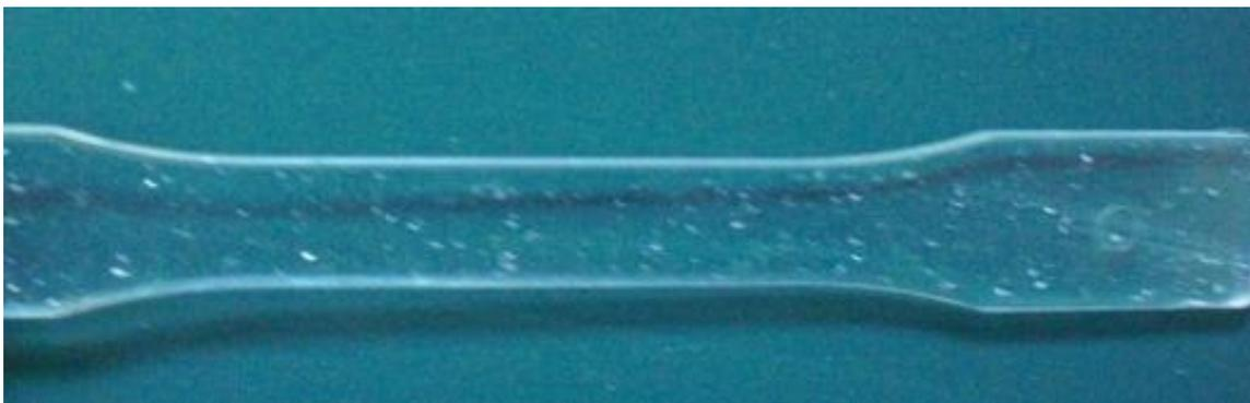
Figura 65. Probeta de policarbonato virgen expuesta a 10 ciclos de hidrólisis.
