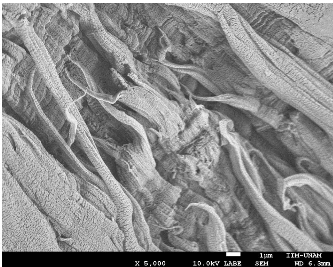
Figura 92. Micrografía de polietileno de alta densidad reciclado sin hidrólisis a 5,000 aumentos
