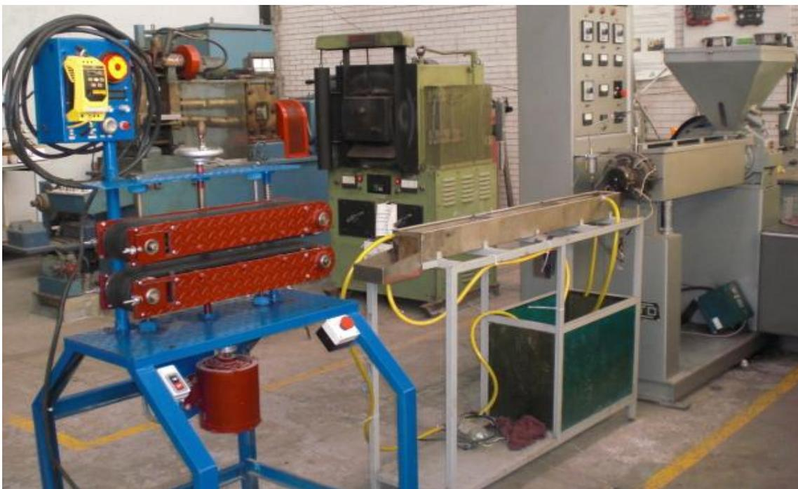
Figura 33. Extrusor de tornillo simple marca Nieto
