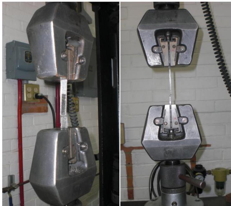
Figura 36. Ensayo de tensión.
