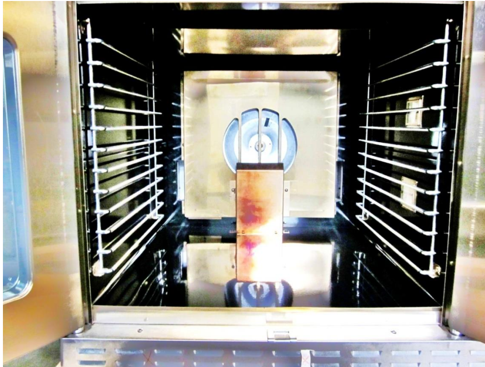
Figura 4.2. Interior de horno donde se monta el motor en estudio.
