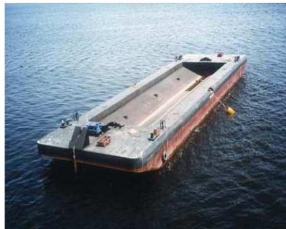
Figura 4.6 Gánguil autopropulsable (izq.) y remolcable (der.)
