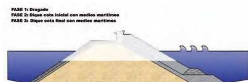
Figura 4.3 Relleno y consolidación
