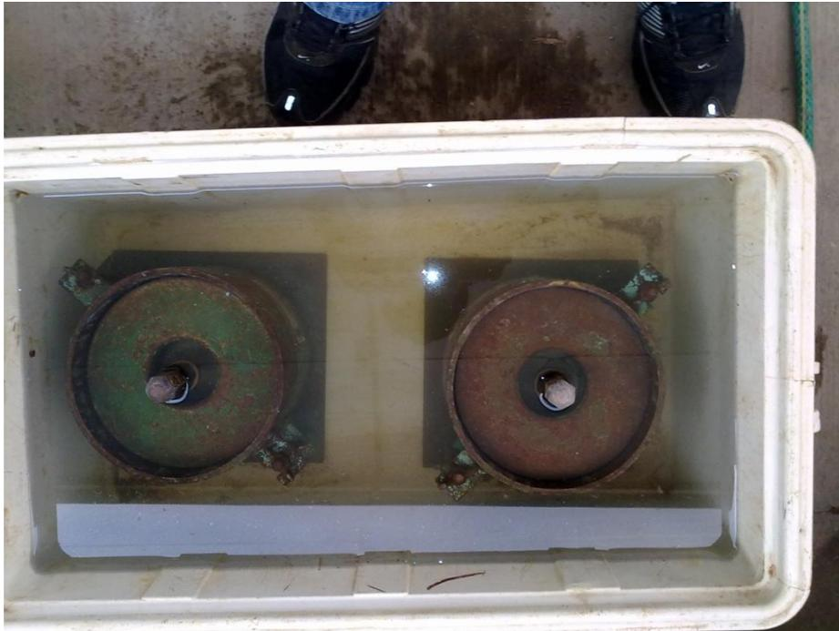
Imagen 2.6.- Suelo saturado para prueba V.R.S.
