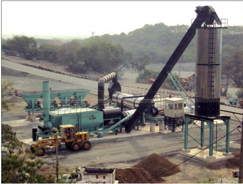
Imagen 1.3.- Planta de mezclado de concreto asfáltico.
