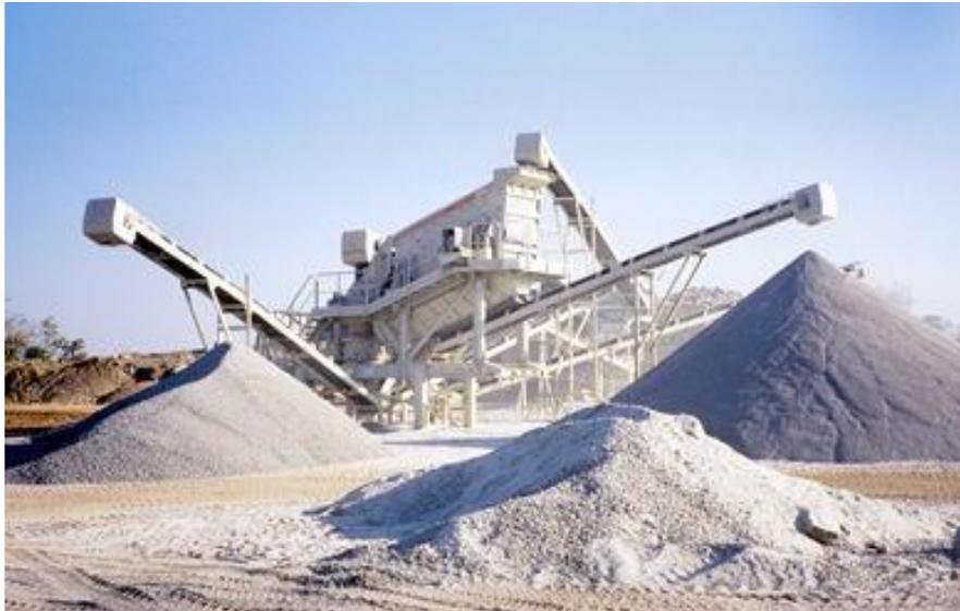
Imagen 1.2.- Planta de trituración para el material pétreo que se utilizara en las carpetas de concreto asfáltico.
