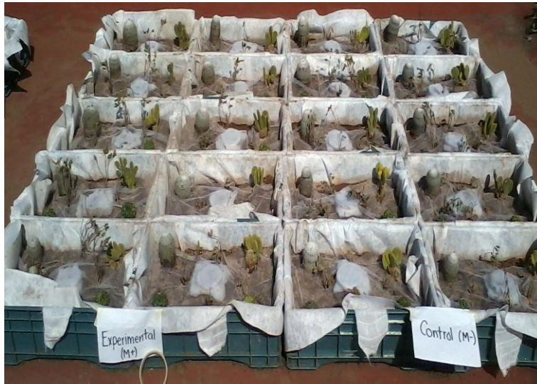
Figura 10. Vista del mosaico de vegetación xerofita ya instalado en la azotea del centro de acopio mostrando su sección experimental y el control.
