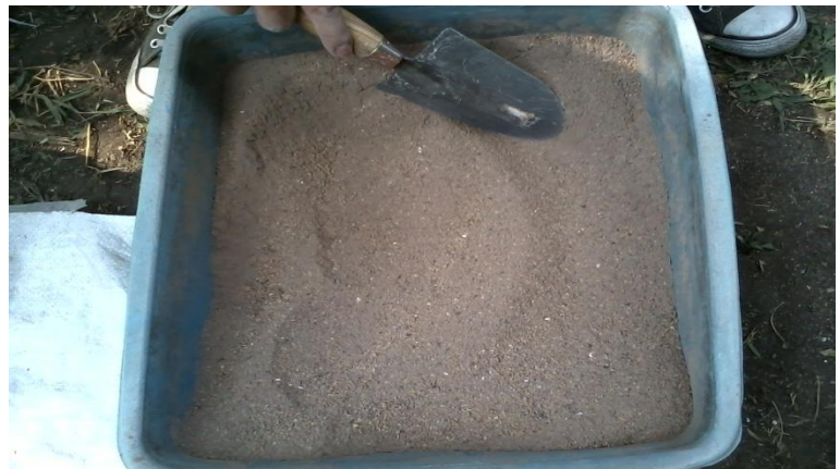
Figura 13. Sustrato preparado con suelo y arena sílica relación 1:2 (v/v).
