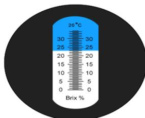
Fig. 18 Escala para medir %SST y °Brix. Tomado de: Atago, 2013
