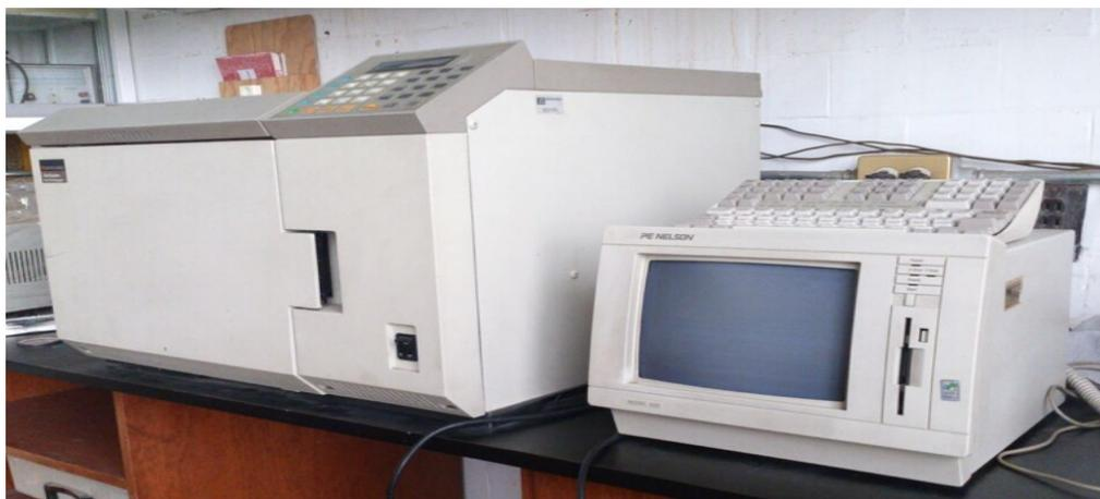
Fig. 19 Cromatógrafo de Gases Perkin-Elmer *Auto System*
