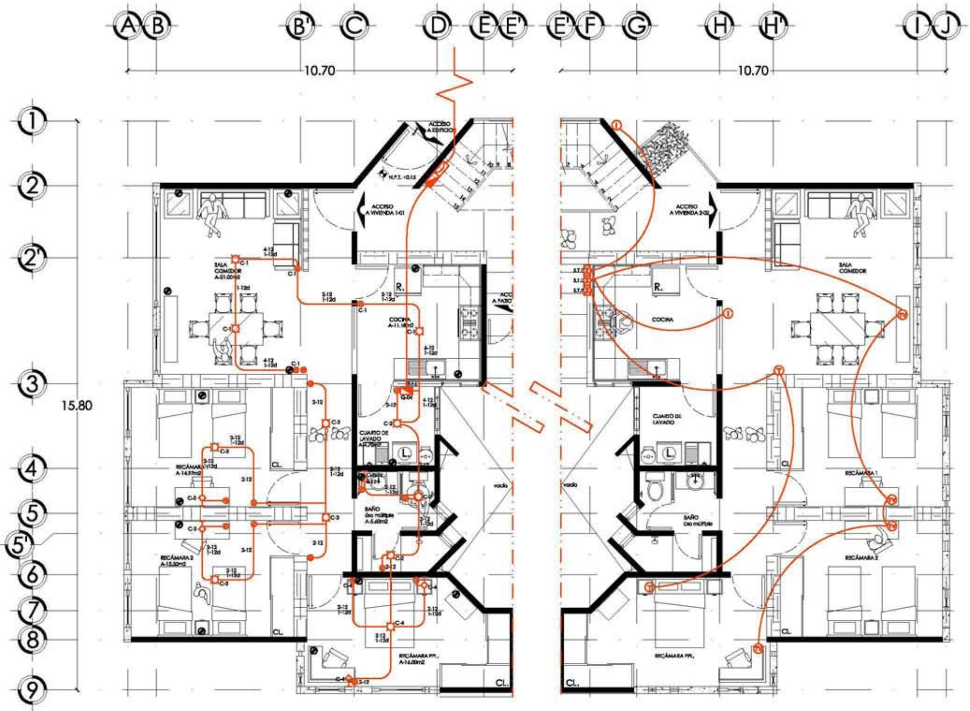
INSTALACIÓN ELÉCTRICA Planta Baja Vivienda Tipo 'A'
