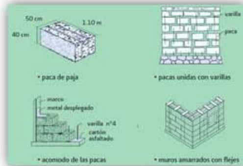
Características, acomodo y unión de las pacas de paja, para un muro.
