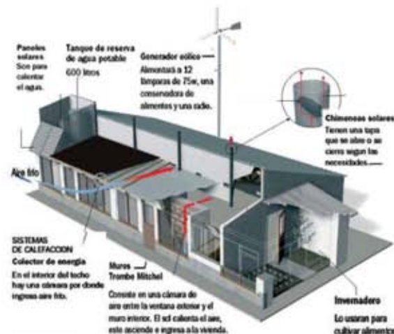
Esquema de una casa ecológica. Fuente: Arq. Eduard Méle, proyectista por el Instituto Provincial de la Vivienda y Desarrollo Urbano de Chubut, Argentina. Infografía: Pablo Loscaí.
