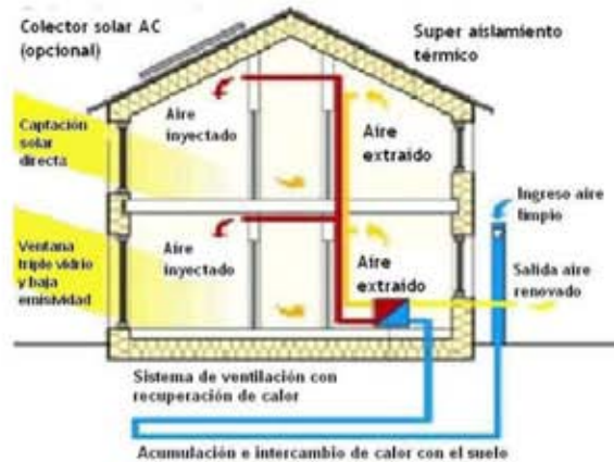
Esquema en corte indicando algunos elementos de una casa pasiva.
