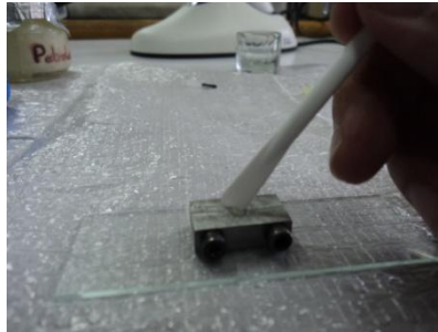
Fig. 2. Colocación del material de prueba en el molde.
