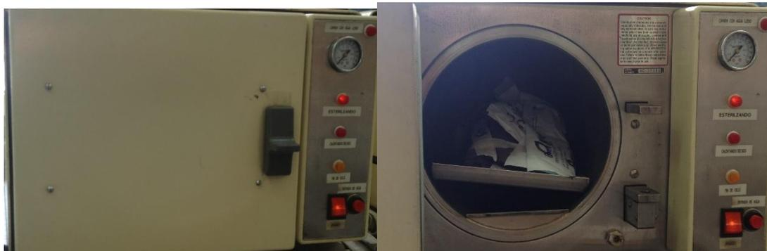
Imagen 12. Muestras dentro del autoclave.
