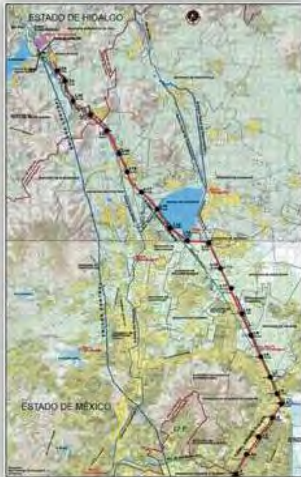
(Fig. 1) Mapa de los 62 Km del Túnel Emisor Oriente. La línea roja muestra las 24 lumberas de la obra.
