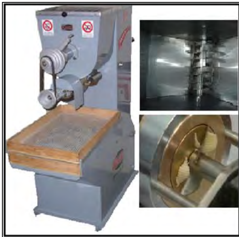
Figura 11: a) Extrusor para pastas, b) torillo, c) molde y corte. Adaptado de: Maquinaria Pama Roma, extrusor de pasta, f.c., Oct. del 2012
