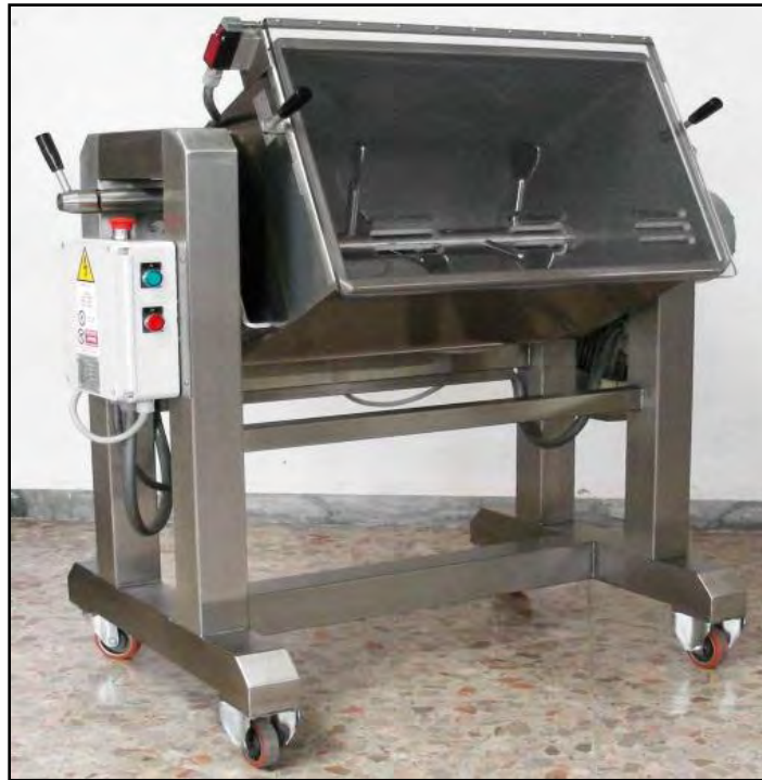
Figura 10: Mezclador de paletas. Fuente: Maquinaria Pama Roma, mezclador de pasta fresca f.c. 2012.
