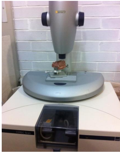
Figura 10. CAD/CAM Cerec Sirona, Fresadora y escáner. Fotografía tomada en la facultad de odontología UNAM laboratorio 2 Honorato Villa.
