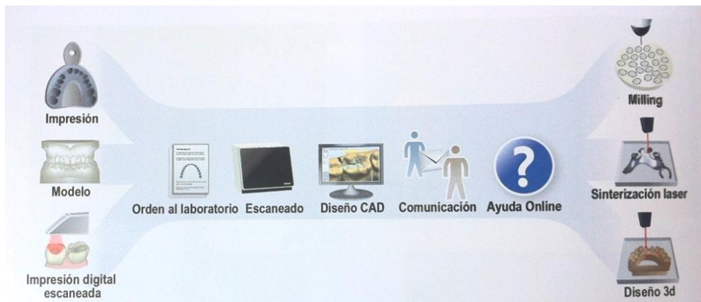
Figura 16. Secuencia completa para la realización de una restauración de circonio hasta la sinterización. 23
