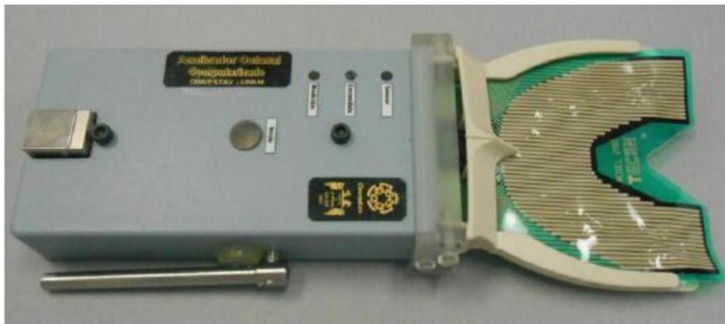
Fig.11 Medidor de fuerza digital con sensor y porta sensor. <sup>FD</sup>
