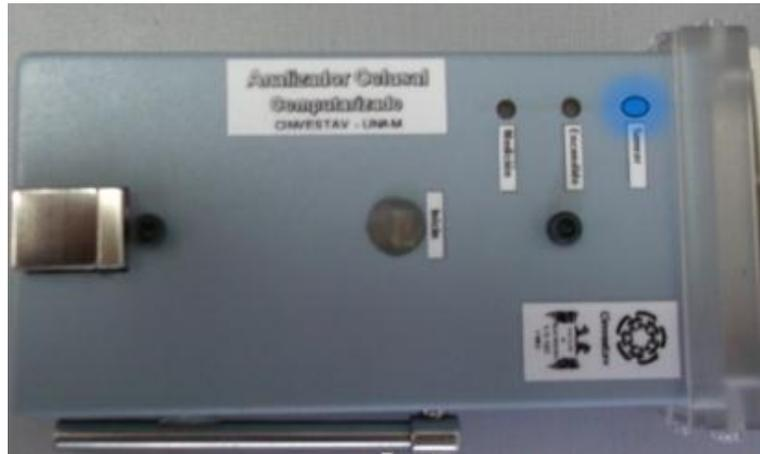
Fig. 3 Dispositivo cuando el paciente hace presión sobre el sensor pero no se está grabando el registro (luz azul eléctrico en la zona de sensor).<sup>FD</sup>
