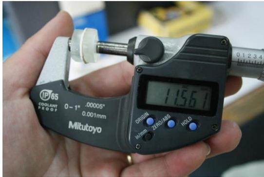
Figura 25. Lectura B: Placas de vidrio con el cemento
