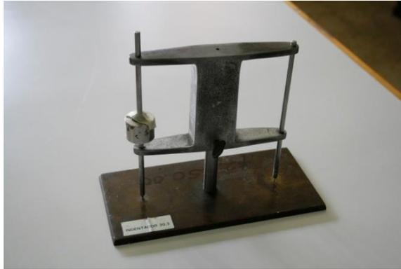
Figura 5. Equipo indentador (Guilmore) para determinar el tiempo de endurecimiento
