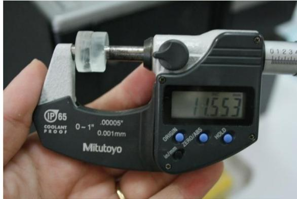
Figura 22. Lectura A: Placas de vidrio sin el cemento
