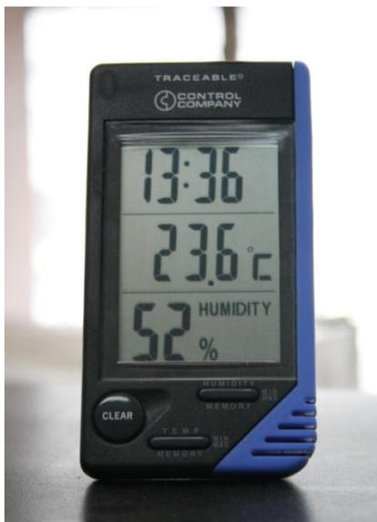
Aparato para medir temperatura y humedad del ambiente
