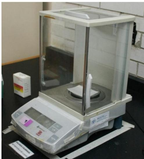
Balanza Calibrada utilizada para medir las proporciones de polvo y líquido de los materiales
