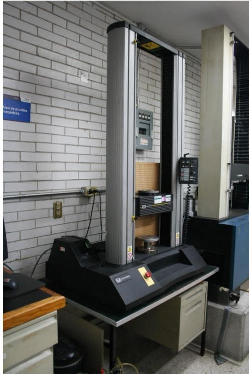
Máquina INSTRON utilizada en el laboratorio para realizar también pruebas de compresión, similares a las que se realizaron con aparato Mecmesin
