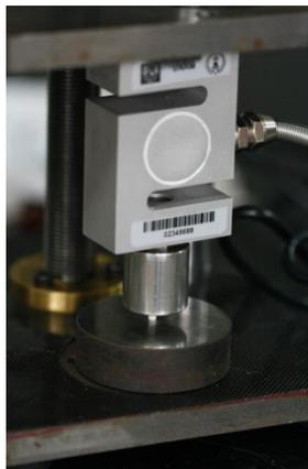
Figura 19. Aplicación de la carga
