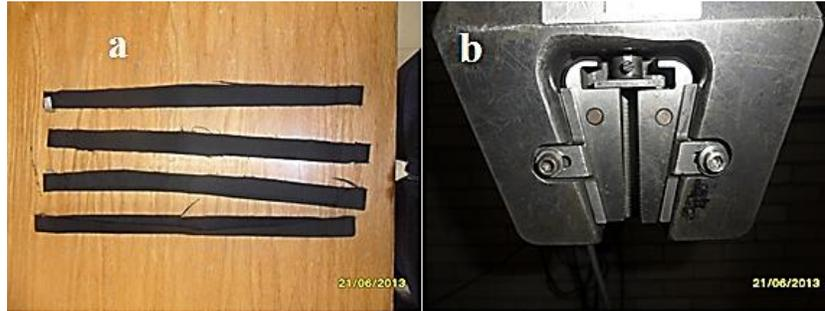
Fig. 43. a) Tiras de polyester para el ensayo de tracción. b) Mordazas utilizadas en el ensayo de tracción. Maya A, Acosta. 2013.
