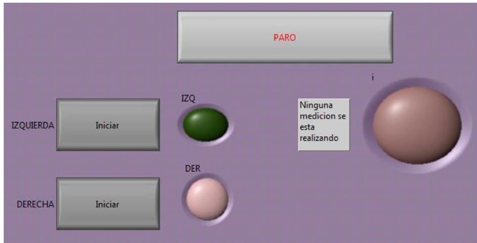
Fig. 69 Interfaz de calibración. Hay dos botones los cuales indica la posición a sensar, esta es elegida por el usuario experto. Maya A, Acosta. 2013.
